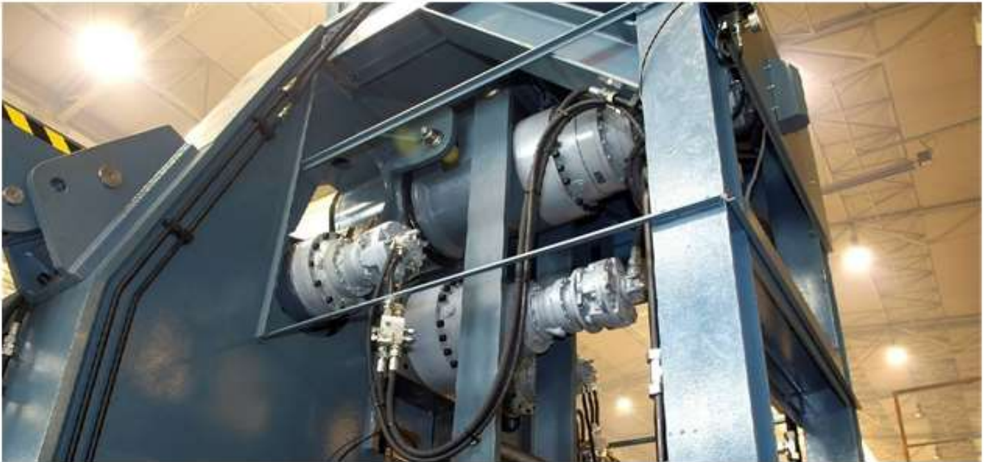
DURMA 4-hengeres vezérlőrendszer
